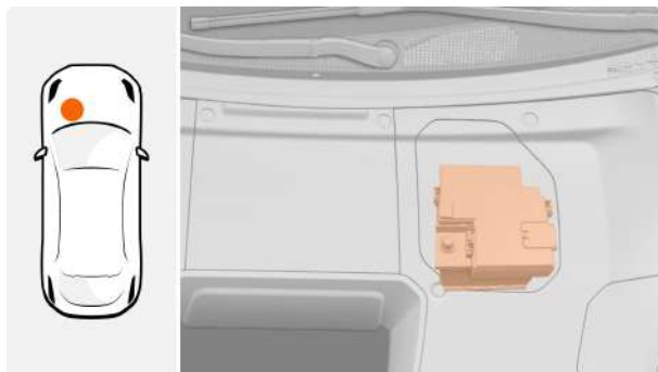
Низковольтная батарея расположена в капоте
