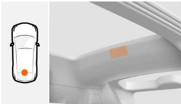
С помощью радарных датчиков на крыше система определяет, не остался ли кто-либо на заднем сиденье после отключения питания или блокировки. При обнаружении пассажиров раздается звуковой сигнал,
