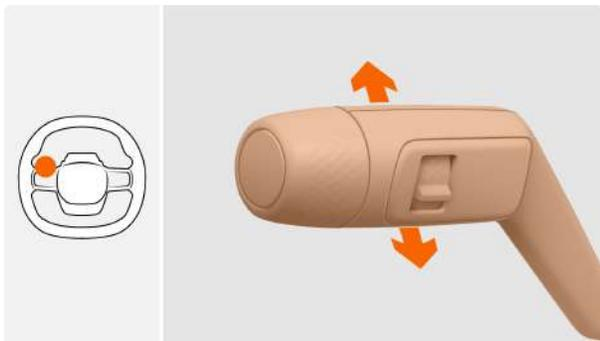
**Вкл:** Когда автомобиль заведен и включен ближний свет, нажмите на подрулевой переключатель один раз, чтобы включить дальний свет.
