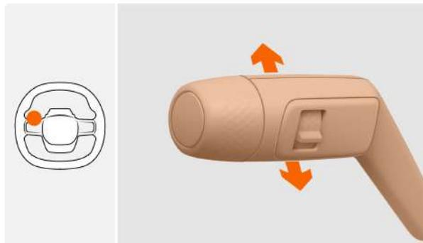
**Вкл:** Чтобы включить АНВ, дважды нажмите на подрулевой переключатель при запуске автомобиля и включении ближнего света фар.
