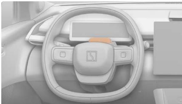
DPS следит за работой водителя с помощью камеры мониторинга. Если будет установлено, что водитель устал или отвлекся, он подаст звуковой или визуальный сигнал, чтобы предупредить водителя и обеспечить безопасность движения.
