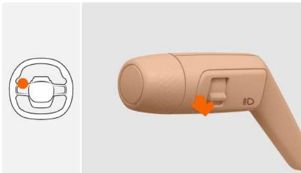
Чтобы включить дальний свет при обгоне впереди идущего автомобиля, можно воспользоваться подрулевым переключателем в направлении рулевого колеса и отпустить его.
