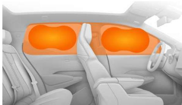
Для защиты пассажиров, сидящих на крайних сиденьях, вдоль обеих сторон потолка установлены шторки безопасности, которые расширяются к А-образной стойке. На панели отделки нанесена надпись "AIRBAG".
