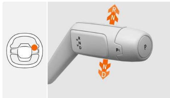
Нажмите на педаль тормоза. Переведите переключатель передач на: Задний ход (R), Нейтральная передача (N) и Движение (D). Информация о соответствующей передаче будет отображаться на дисплее прибора.
