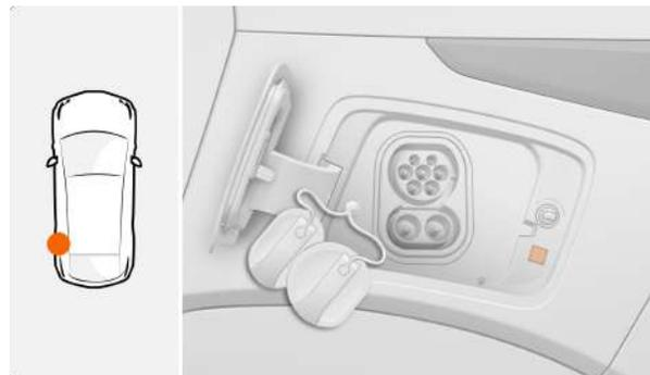
Светодиодный индикатор отображает разные цвета в зависимости от состояния зарядки.
